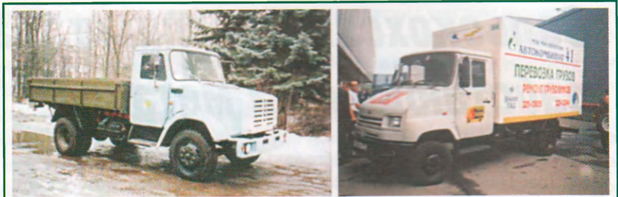
Рис. 2. Работающие на КПГ газодизельный автомобиль ЗИЛ-432900 и автомобиль ЗИЛ-5301 с конвертированным газовым двигателем и зажиганием от искры
